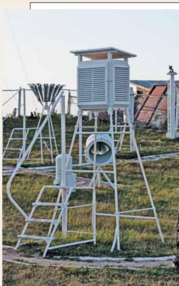
Оборудование метеорологической станции. На первом плане — метеорологическая будка, где расположены термометры и гигрометры (измерители влажности). Слева — измеритель количества осадков в виде раскрытоого цветка. Справа, на столбике, — гелиограф, отмечающий продолжительность солнечного сияния, т. е. часы хорошей погоды.
