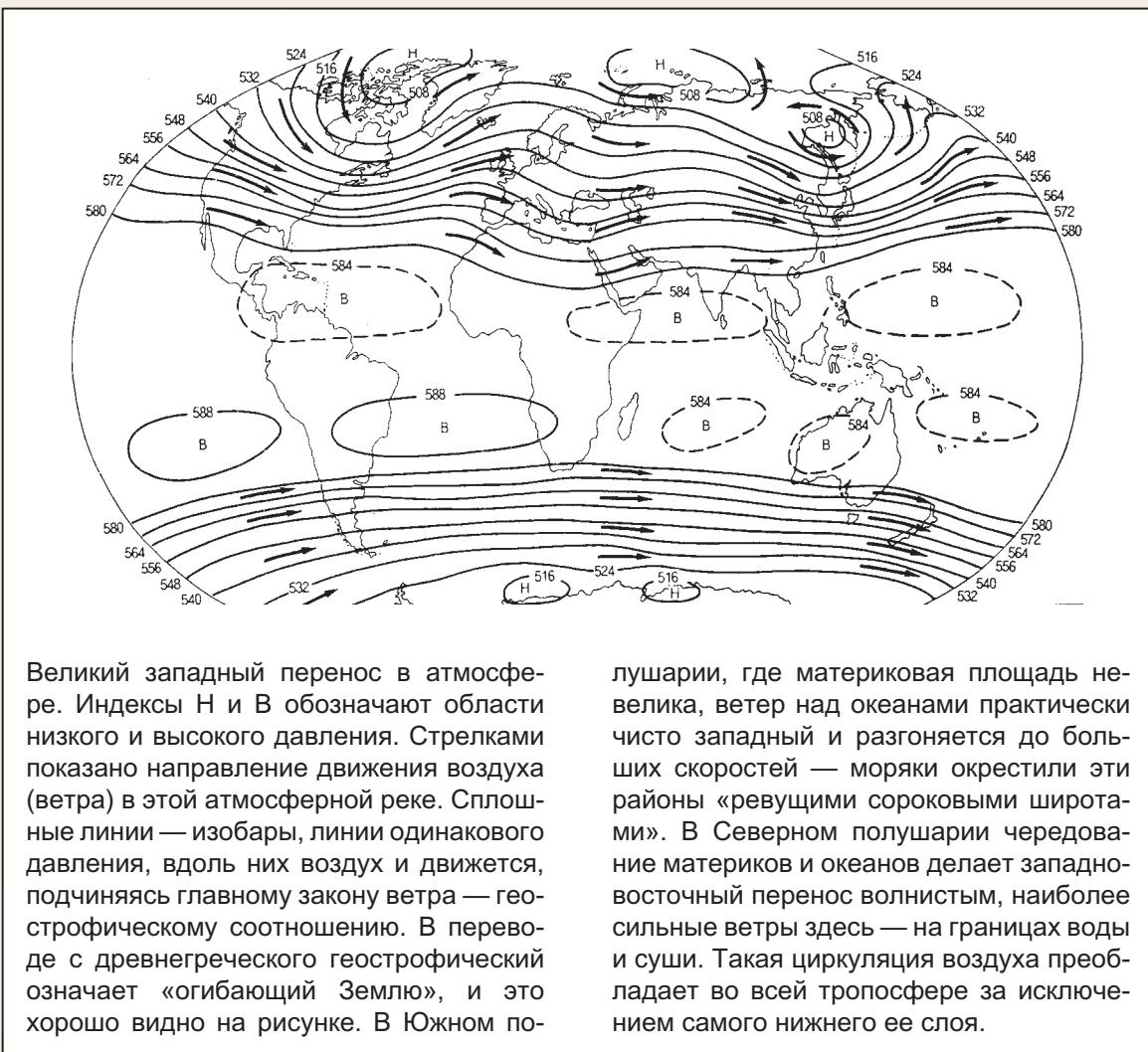
Великий западный перенос в атмосфере. Индексы Н и В обозначают области низкого и высокого давления. Стрелками показано направление движения воздуха (ветра) в этой атмосферной реке. Сплошные линии — изобары, линии одинакового давления, вдоль них воздух и движется, подчиняясь главному закону ветра — геострофическому соотношению. В переводе с древнегреческого геострофический означает «огибающий Землю», и это хорошо видно на рисунке. В Южном по-
