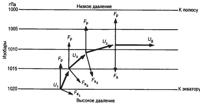
Барический закон ветра (закон Бейс-Балло). Под действием силы барического градиента воздух от высокого давления начинает двигаться к низкому, ветер при этом будет южным. Но как только воздушная масса сдвинется с места, сразу начнет действовать сила Кориолиса, отклоняющая ее к востоку. С усилением скорости ветра  $U$  сила Кориолиса и ее отклоняющее действие будут становиться все больше. Наконец, наступит такой момент,
