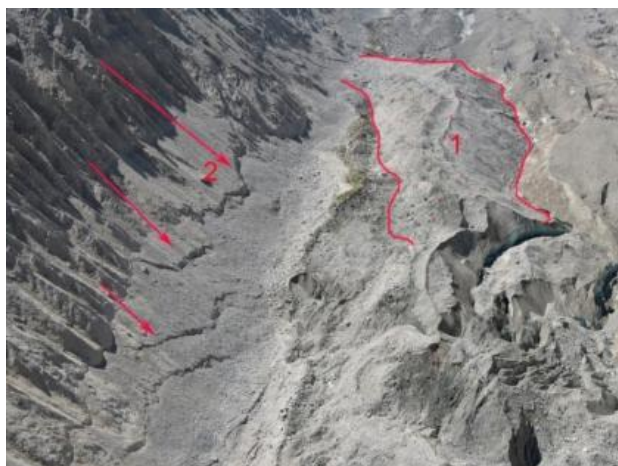
Рисунок 12.3 – Обломочный чехол селевых отложений 2016 года на поверхности ледника Безенги (№1) и линии отрыва сползающего пролювиально-коллювиального шлейфа подножия склона (№2) (фото с квадрокоптера 11.09.2024)
