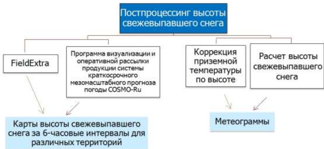
Рис.3. Схема постпроцессинга высоты свежеснежавшего снега в Гидрометцентре России (на основе мезомасштабной модели COSMO-Ru)
