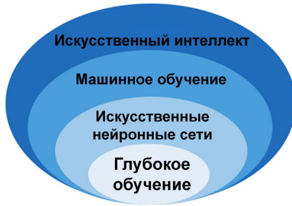
Рисунок 1.2 – Схема, иллюстрирующая иерархическую связь между искусственным интеллектом, машинным обучением, искусственными нейронными сетями и глубоким обучением, из [Fang et al., 2022]
